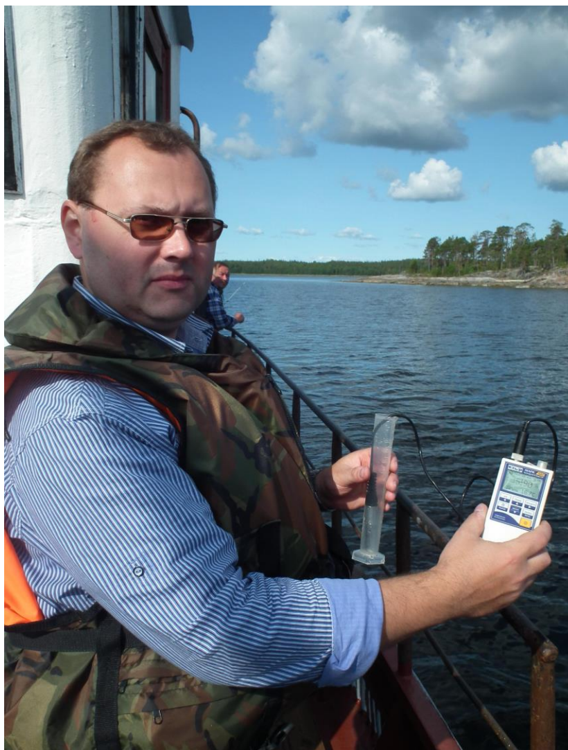
Фото 18 - Руководитель производственной Практики по Экологии РГГМУ на Белом море доцент В.В. Дроздов анализирует минерализацию воды портативным электронным прибором-кондуктометром «МАРК-603» с борта НИС «Беломор».
