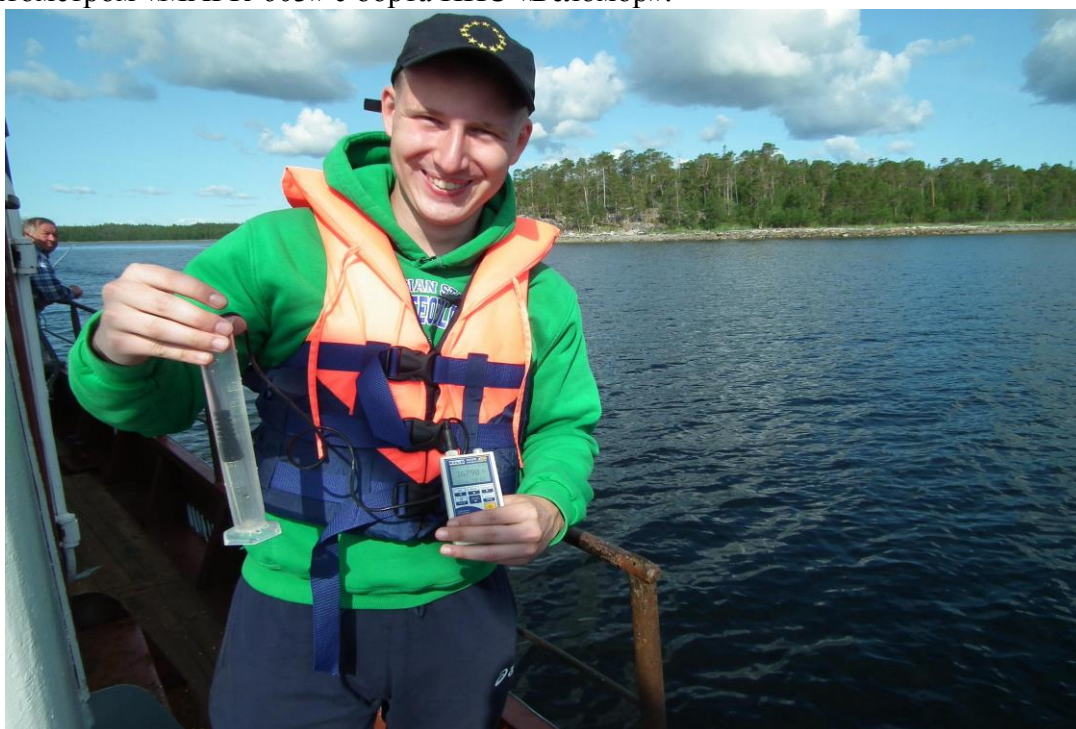
Фото 19 - Студент В. Эйсмонт, техник НИС РГГМУ, анализирует минерализацию воды портативным электронным прибором-кондуктометром «МАРК-603» с борта НИС «Беломор».
