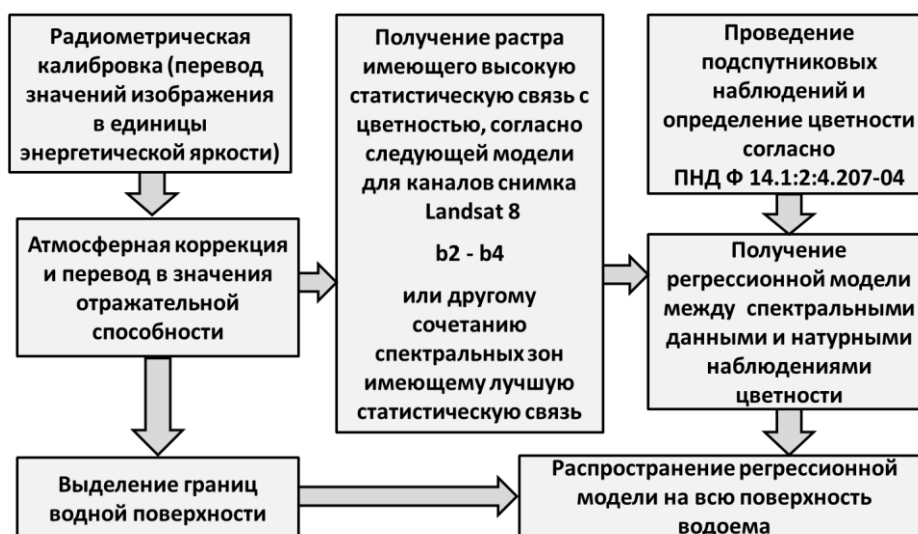
Рис. 17. Блок схема алгоритма определения цветности воды по данным сенсора OLI спутника Landsat-8 в оптическом диапазоне
